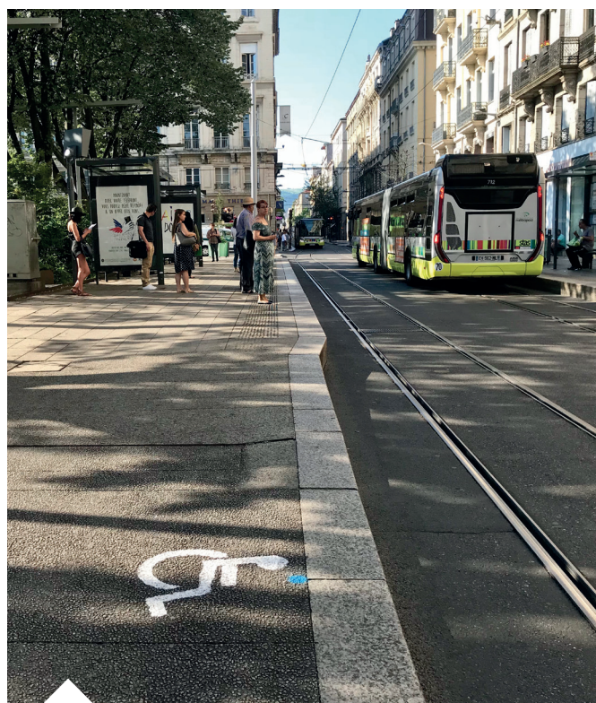
Quai de tramway surélevé
